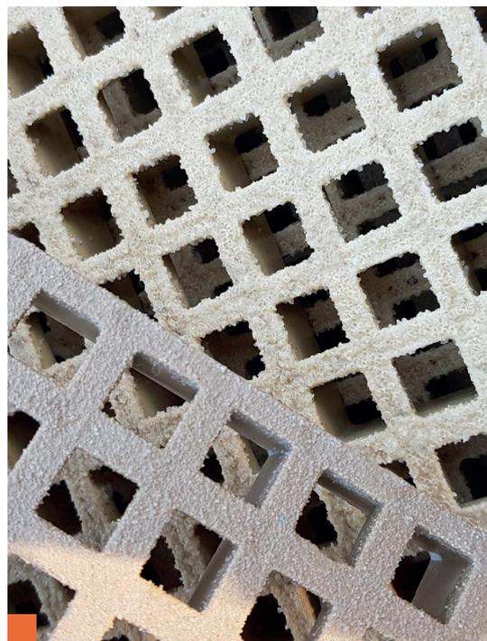
**GFK Gitterroste bilden einen sehr stabilen Decksbelag, wodurch dieser Belag ideal für eine intensive Nutzung geeignet ist. Es ist eine zu 100 % recycelbare Polymeralternative zu Holz und Kunststoff. GFK-Gitterroste sind langlebig (UV-stabilisiert), haben eine lange Lebensdauer und können durch die Glasfaserverstärkung eine sehr große Spannweite erreichen.**
